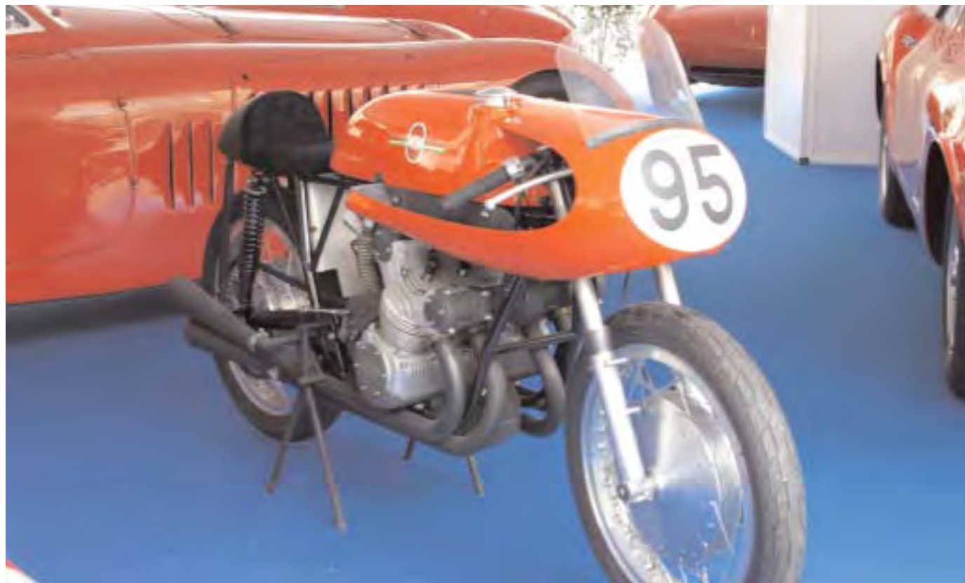
Gilera 500 500 cm 3 , 65 CV, a 4 cilindri inclinati di 30°,
