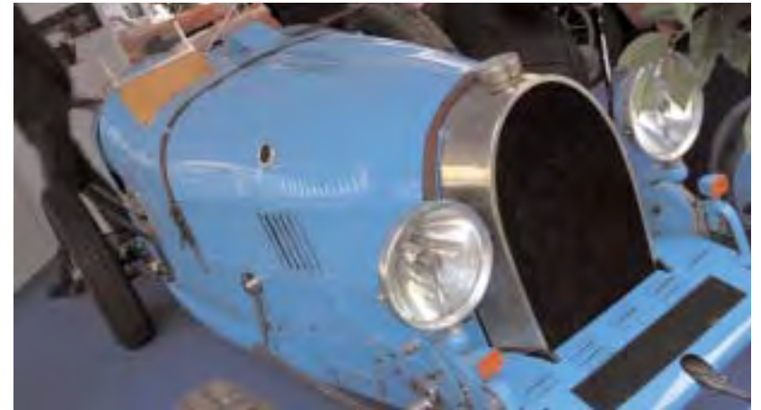
Bugatti T35A del 1925, 8 cilindri, (replica) 1991 cm 3 , 80CV,
