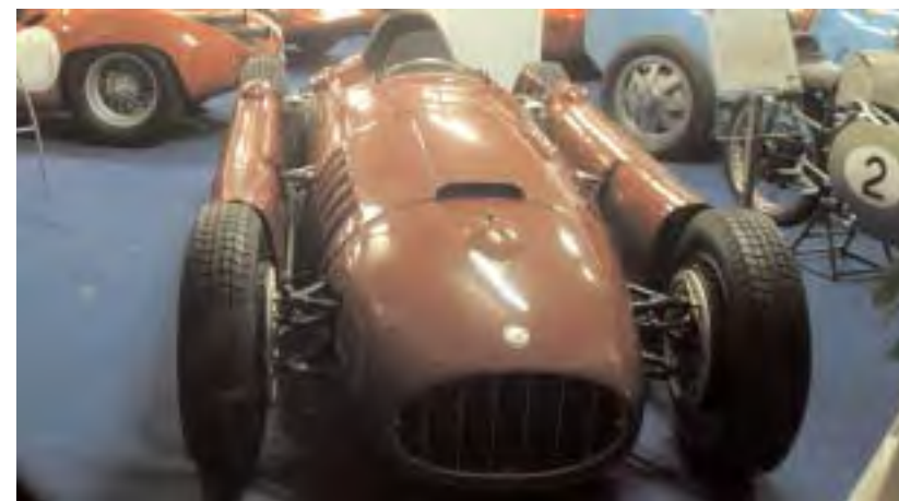
Lancia D50 Formula 1, 8 cilindri a V di 90°,
