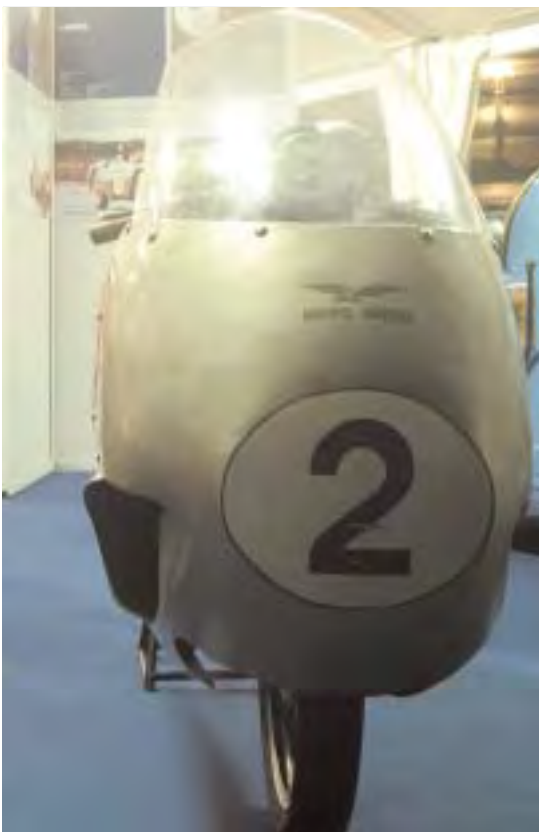
Moto Guzzi 500, 500 cm 3 , 79 CV, 8 cilindri a V di 90°,
