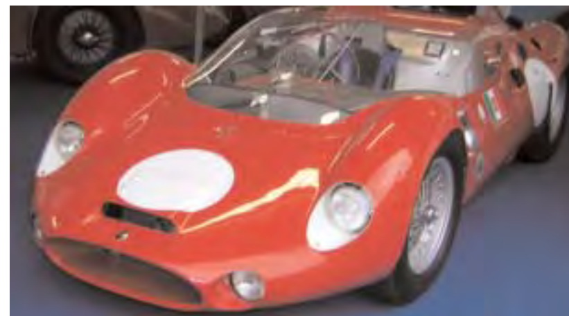
Maserati Sport di 60° posteriore, tipo 63 Birdcage, 3000 cm 3 , 320 CV, 12 cilindri a V del 1961
