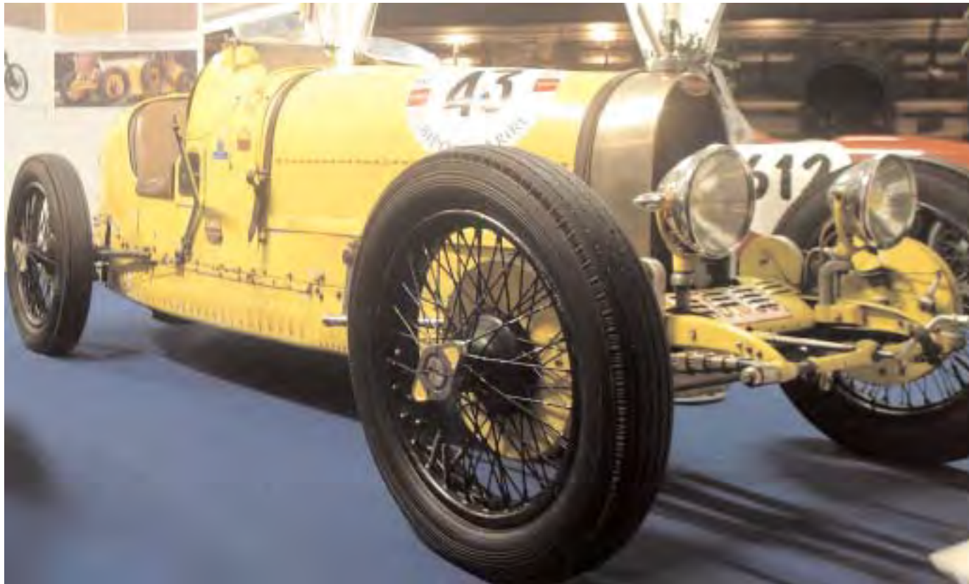
Bugatti T35A 1991 cm 3 , 80CV, 8 cilindri, del 1925
