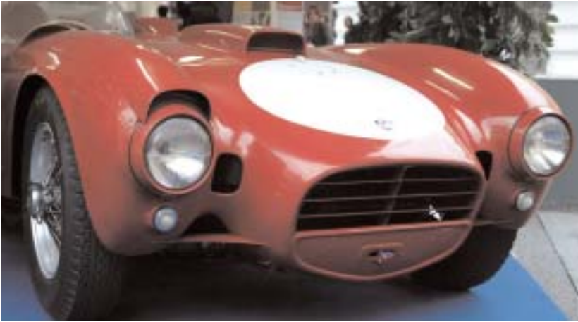
Lancia D 24 Sport, 6 cilindri a V di 60°, 3284 cm 3 , 265 CV, del 1953, (replica)
