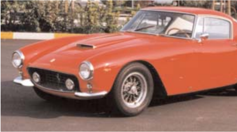
Ferrari 250 GT Berlinetta passo Corto, 12 cilindri a V di 60°, 2953 cm 3 , 240 CV, del 1962
