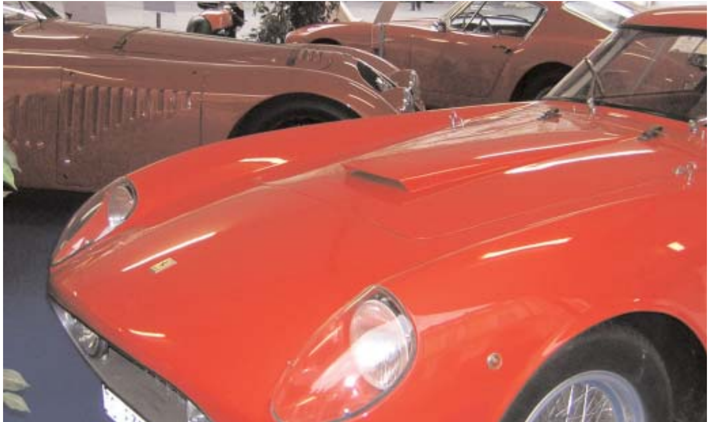
Ferrari 250 GT Berlinetta passo Lungo, 12 cilindri a V di 60°, 2953 cm 3 , 240 CV del 1958
