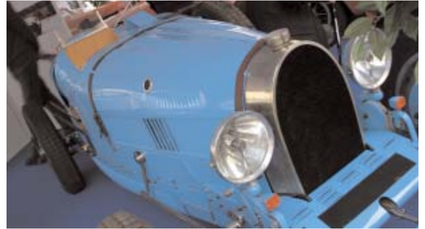
— Bugatti T35A del 1925, 8 cilindri, (replica) 1991 cm 3 , 80CV,
