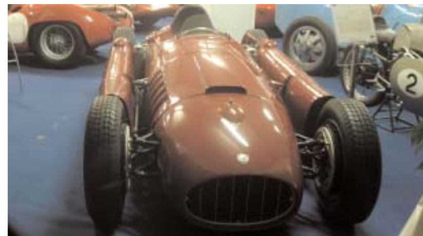
Lancia D50 Formula 1, 8 cilindri a V di 90°,
