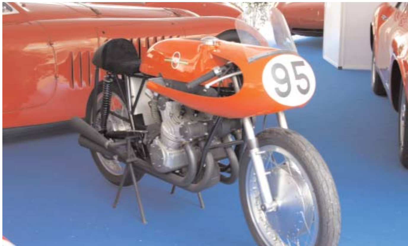
Gilera 500 a 4 cilindri inclinati di 30°, 500 cm 3 , 65 CV, del 1957
