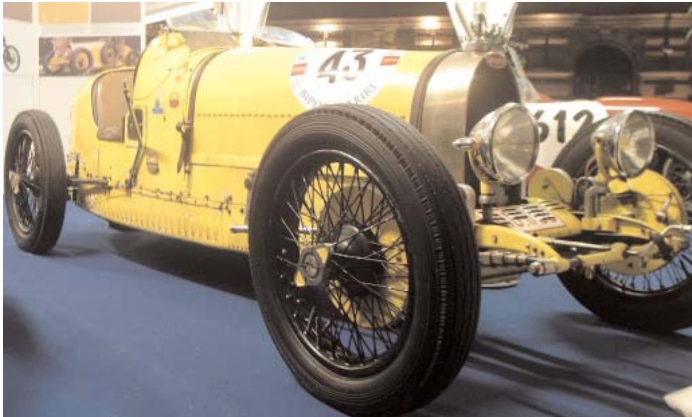
— Bugatti T35A 1991 cm 3 , 80CV, 8 cilindri, del 1925
